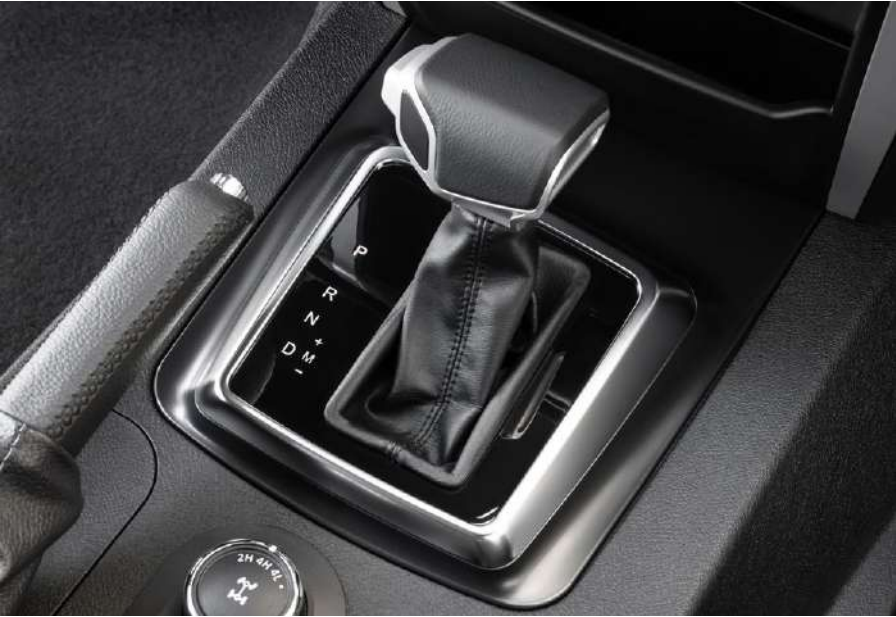
El modo de cambio manual permite controlar la transmisión automática con mayor precisión y usar la potencia de motor, simula el funcionamiento de la caja mecánica con incremento o disminución secuencial de la transmisión cuando la palanca está en la posición "+/-".
